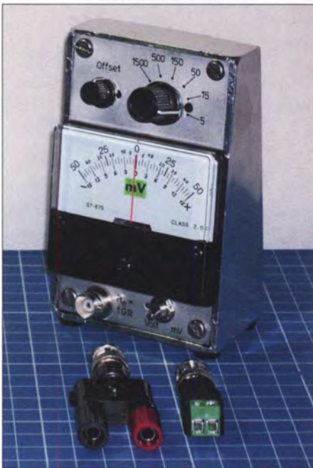
Bild 1: Das Messgerät ist in ein Pultgehäuse eingebaut. Dessen Hochkantordnung erfordert nur eine kleine Stellfläche und ermöglicht bequemes Ablesen.
