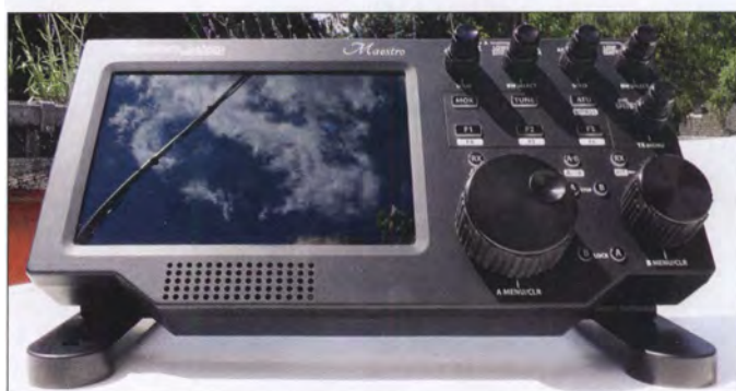
Bild 16: Reflexionen durch helle Flächen auf dem nicht entspiegelten Display
