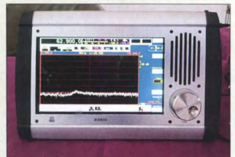
Der tragbare Empfänger Reuter RDR53 ist ein frei konfigurierbarer KW-Receiver mit Optionen für UKW/2-m-Empfang und -Sendeetrieb. Sein helles und großes Display mit Touch-Bedienung erlaubt den Betrieb flach liegend oder aufrecht stehend.
