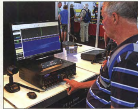
Spektrumdarstellungen an Yaesu-Transceivern, hier am FTdx5000, werden durch einen SDRplay RSP-RX am ZF-Ausgang möglich.
