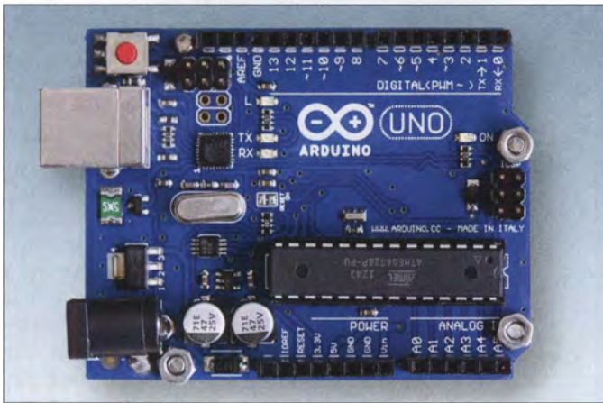
Bild 1: Arduino Uno mit aufgestecktem Mikrocontroller; links oben befinden sich ein Reset-Taster und die Buchse zum Anschluss des USB-Verbindungskabels zum PC, links unten ist die Buchse für die Gleichspannungsvorsorgung mittels Steckernetzteil zu sehen.
