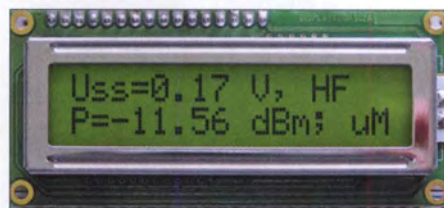
Bild 7: ... und bei einer HF-Messung, hier mit dem auf 50 \Omega bezogenen Leistungspegel
