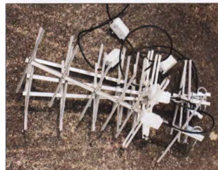
Bild 2: Komplette mit den Stockungsleitungen verkabelte, transportfertige Vierergruppe
