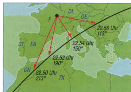
Bild 8: Flugverlauf der ISS am 21. 3. 2017; die Beobachtungswinkel beziehen sich auf den Standort des GRAVES-Radars.
