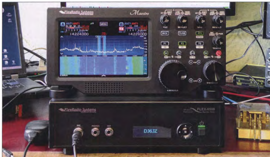
Bild 13: Flex-6500 bei DJ6JZ im praktischen Einsatz – hier im Zusammenwirken mit der Bedieneinheit Maestro
