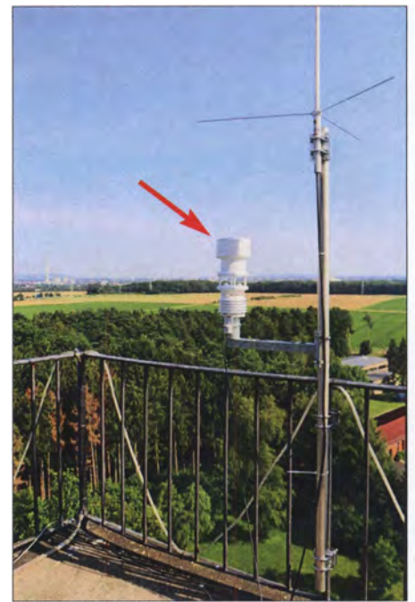
Wetterstation WS601-UMB von G. Luft Mess- und Regeltechnik GmbH bei DLOPTB Foto: DB2TK
