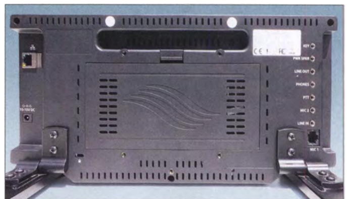
Bild 14: Die Maestro -Anschlüsse auf der Rückseite: rechts sieben 3,5-mm-Klinkenbuchsen für Morsetaste, Aktivlautsprecher, Line-Ausgang, Kopfhörer, PTT, Mikrofon und Line-Eingang, darunter eine RJ45-Mikrofonbuchse; in der Mitte das Fach für die Powerbank
