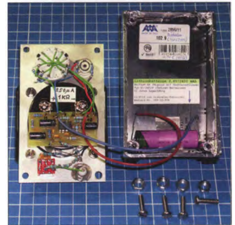
Bild 2: Blick in das geöffnete Gerät; alle Komponenten sind auf der Aluminiumfrontplatte montiert. Lediglich die Batterie ist im Kunststoffrückteil fixiert. Fotos: Franke
