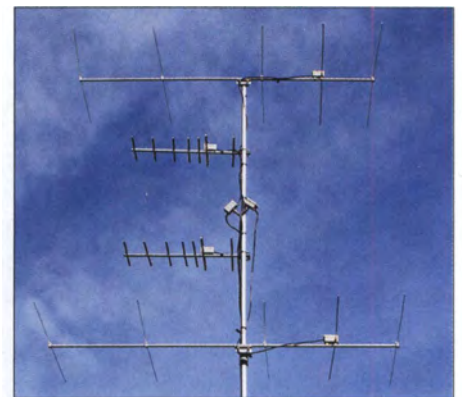
Bild 9: Gestockte 70-cm-Gruppe zwischen zwei 2-m-Yagi-Antennen [6]
