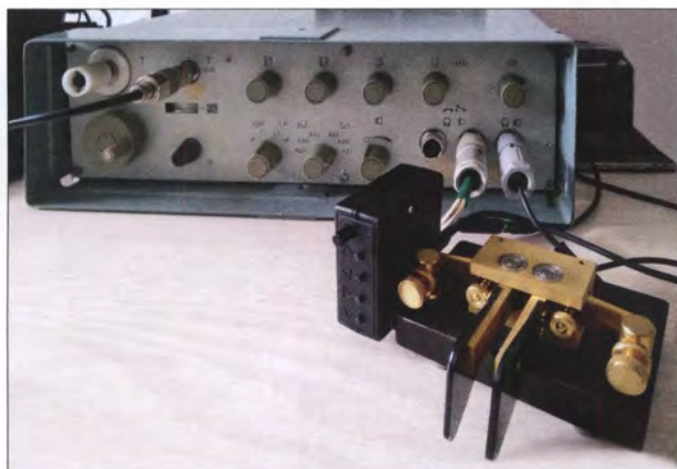
Bild 1: SEG 15 D beim Betrieb auf 60 m mit angeschloss- nem Doppelpaddle und Ultra PicoKeyer
