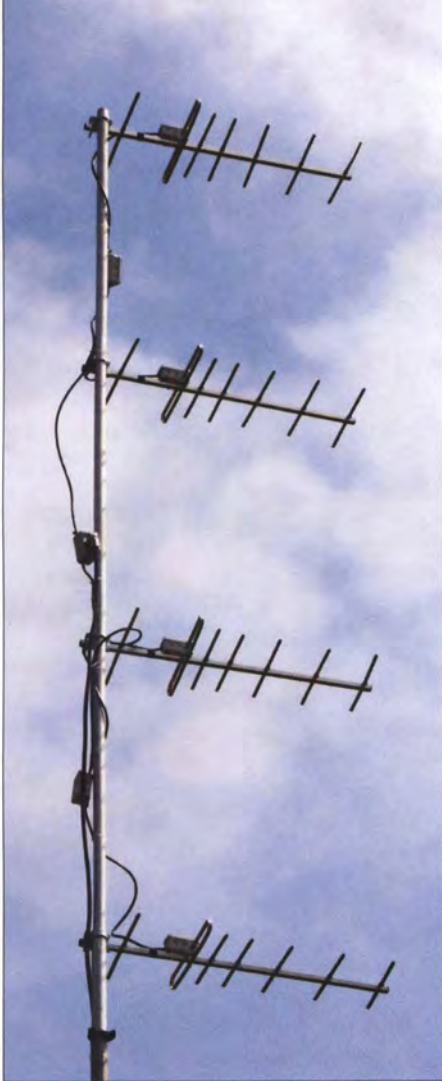
Bild 5: Vierergruppe der umgebauten 70-cm-Yagi-Antennen am Mast
